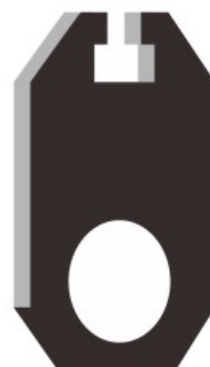
带导流孔型闸板
